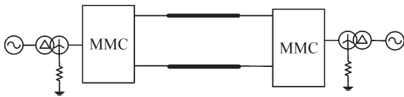
图3 系统主接线形式
